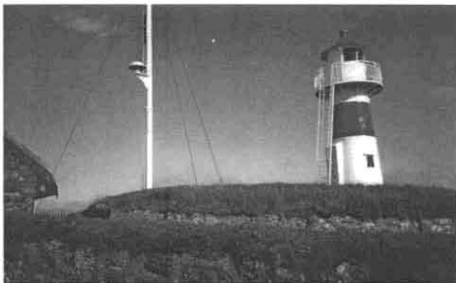
Á myndini hómast 20M dpolurin sum hongur millum sjálvan vitan og flaggstongina. Hin antennen ein longwier ca. 40 M var strekt frá flaggstongini og sett fæst í kumpashúsi
